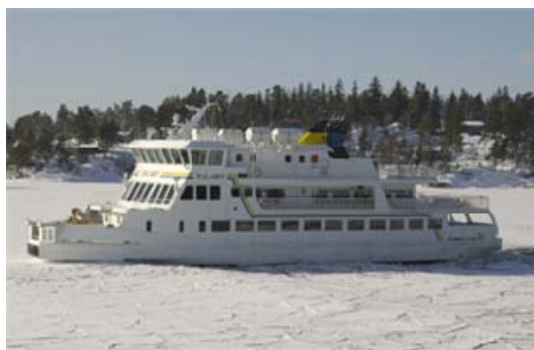
Fartyget Dalarö, isgående och med lastutrymmen för att kunna transportera gods under lågsäsong
